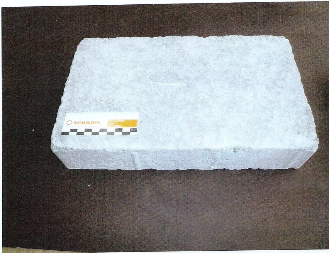
Bild 1: Natulit-Platte mit den Abmessungen 350 mm x 210 mm x 70 mm
