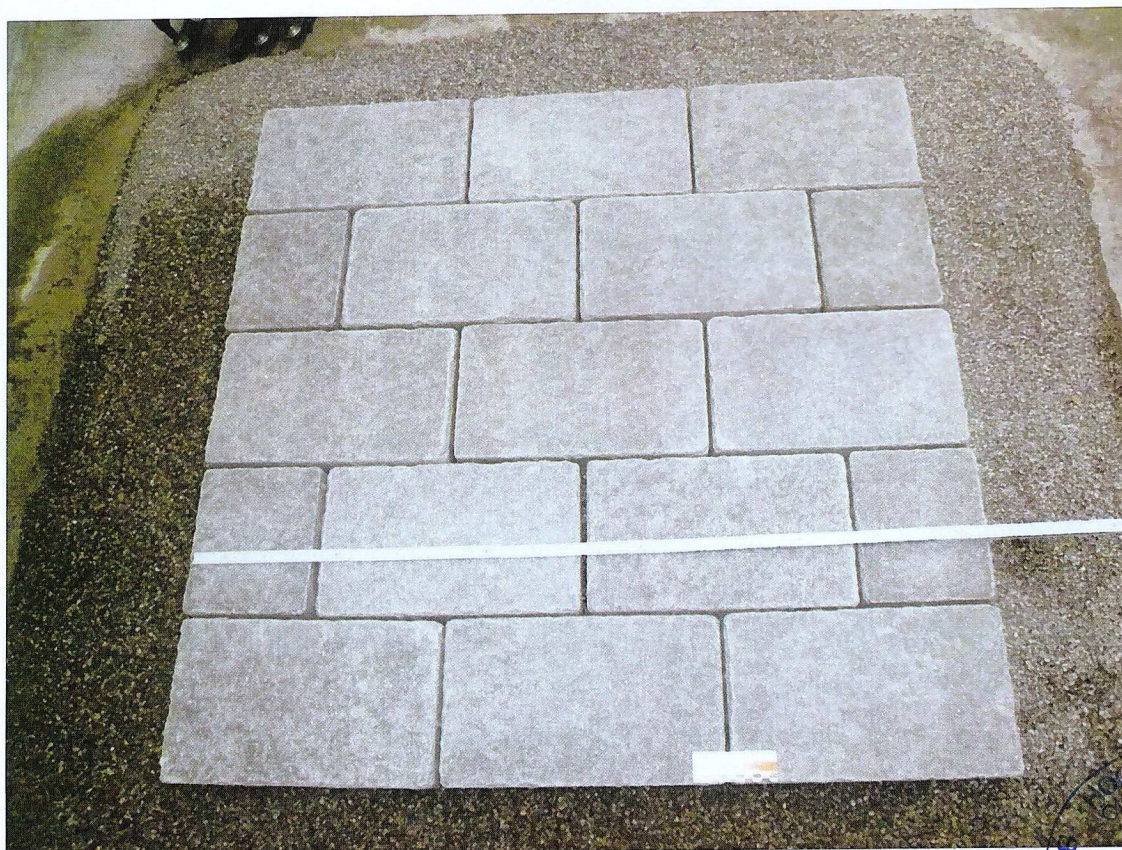
Bild 2: Vorgeschlagene Musterfläche des Natulit- Plattensystems mit Rastermaß 350 mm x 210 mm und Plattenhöhe 70 mm, verlegt im Läuferverband
