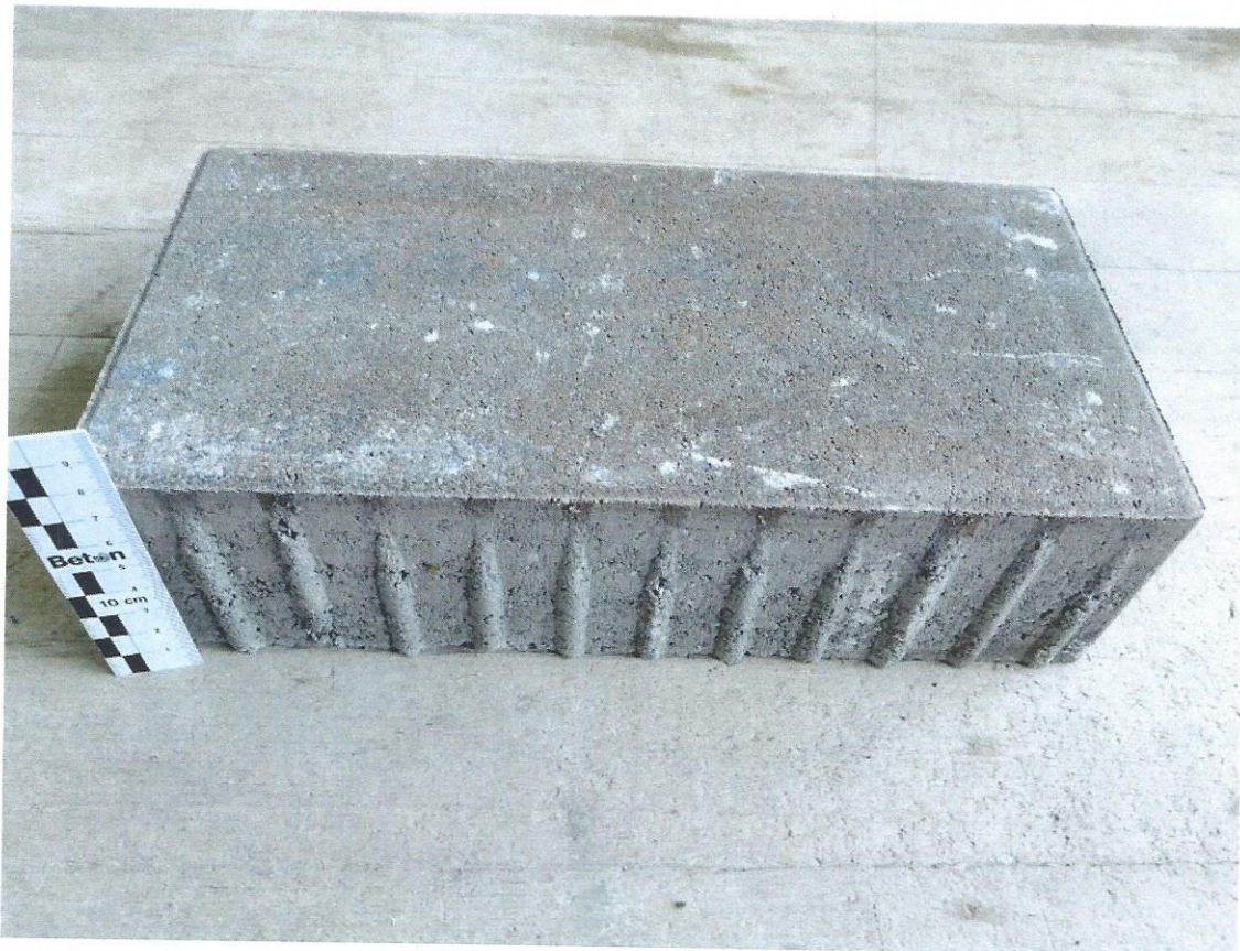
Bild 1: Betonpflastersystem „CUADRETE“, Seitenansicht Pflasterstein, Steinhöhe 80 mm, mit ausgebildeten Abstandshaltern
