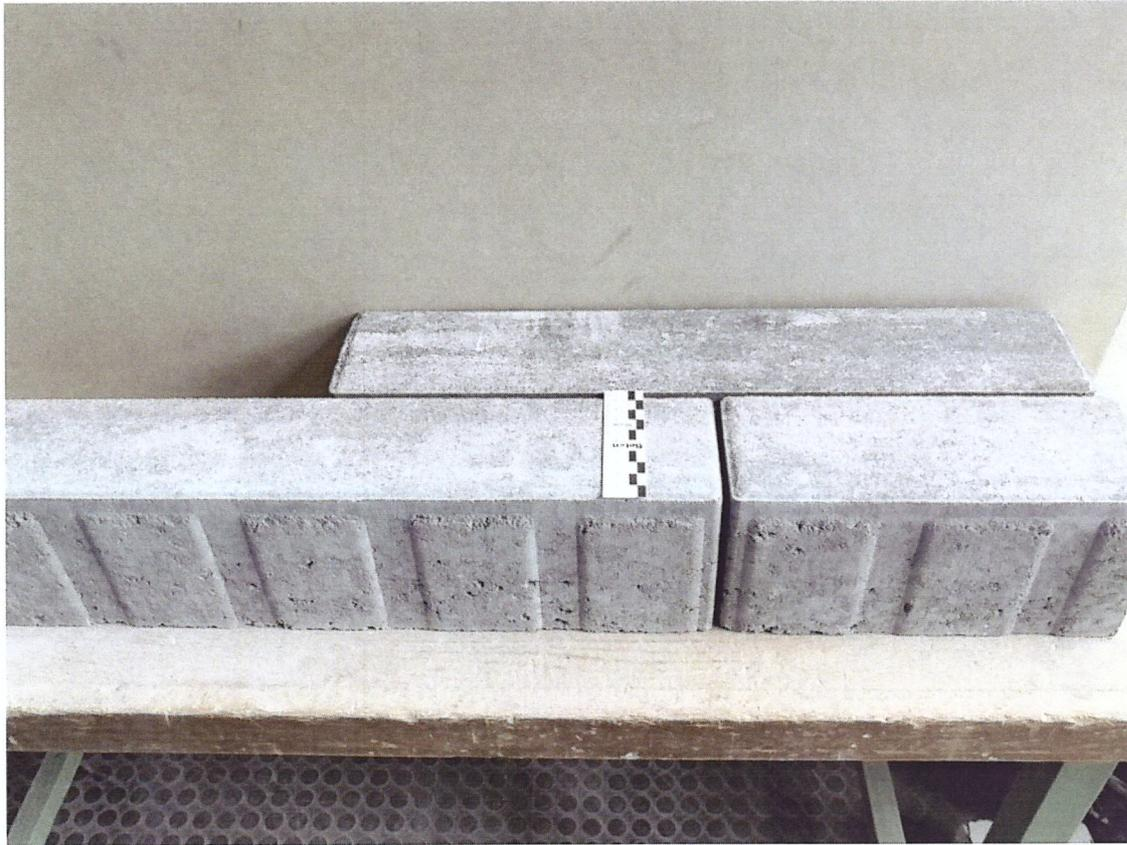
Bild 1: Betonpflastersystem „ARTLINE SLIM“, Seitenansicht Pflasterstein, Steinhöhe 120 mm, mit ausgebildeten Abstandshaltern
