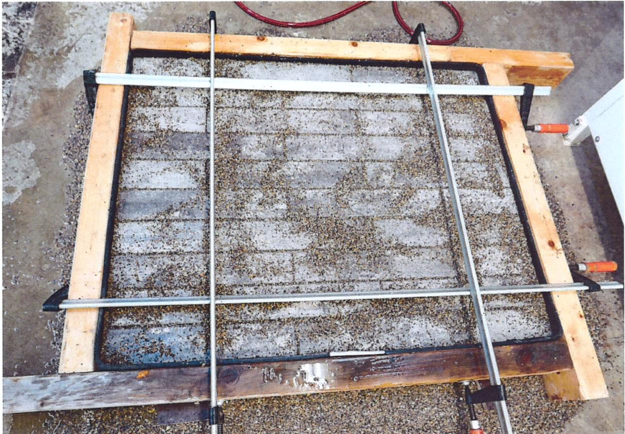
Bild 3: Vorbereitetes Versuchsfeld für die Bestimmung der Versickerungsfähigkeit
