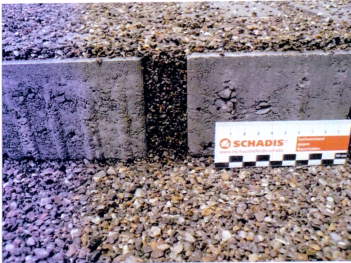
Bild 5: Detailansicht, Fuge nach Bewässerung
